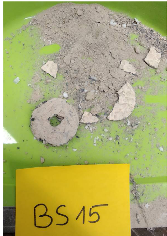
Alter Raum hinter GFK: Putz auf Heraklith/Styropor/Heraklith [BS15]
