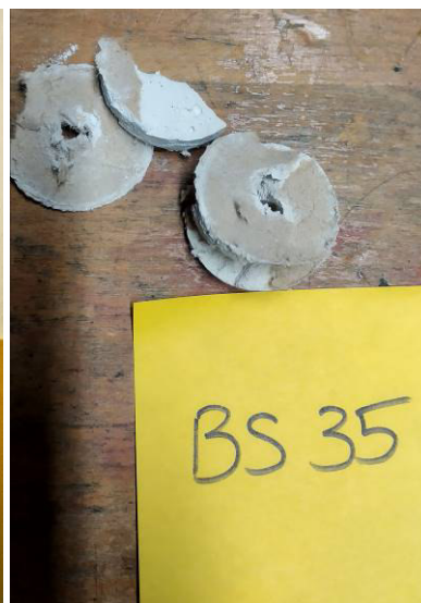
Wand unter Fenster Materialraum: Gipskarton [BS35] und Dämmmaterial hinter Gipskarton [BS36]
