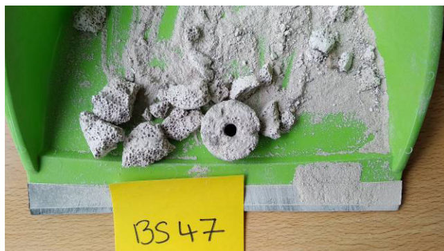
Wand hinter Heizung Klassenzimmer: Putz auf Leichtbeton [BS47]
