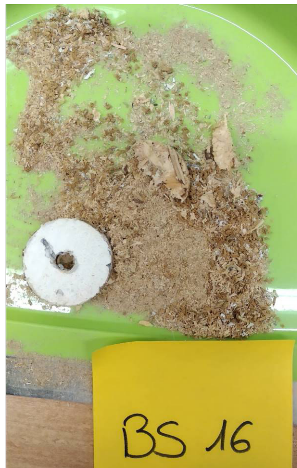
Lehrerzimmer unter Schreibtisch: Trennwand aus 2 Spanplatten ohne Dämmung [BS16]
