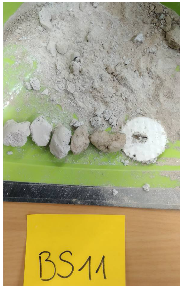
Strukturputz, Putz, Leichtbeton, Wand hinter Heizung Klassenzimmer [BS11]
