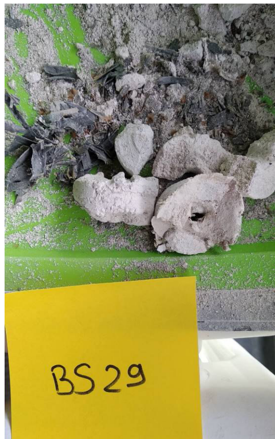
Abgehängte Decke, Gipskarton auf Putz mit Heraklith [BS29]
