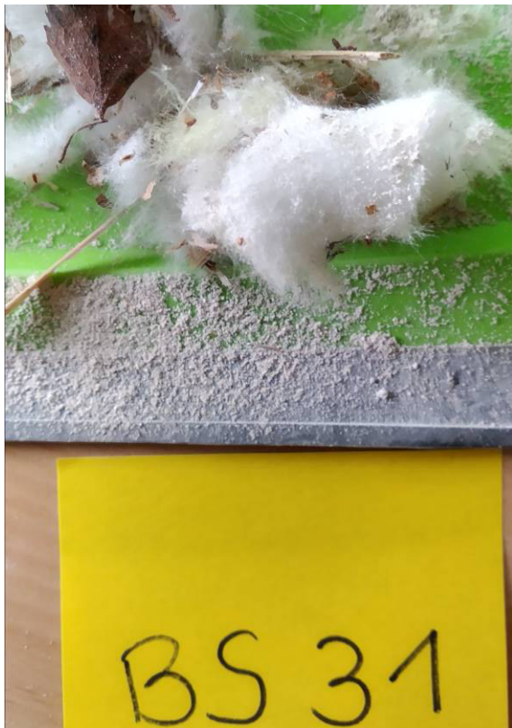
Schilf + Dämmmaterial hinter Putz Decke [BS31]
