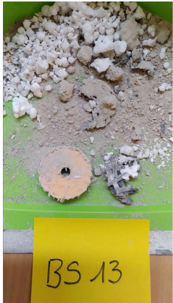
Leichtbauwand auf Heraklith auf Styropor [BS13]
