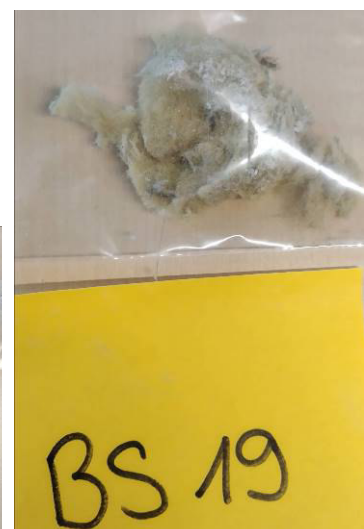
Putz auf Gipskarton [BS18] und Dämmmaterial hinter Gips [BS19]
