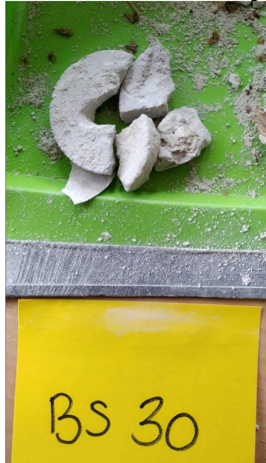
Abgehängte Decke, Putz [BS30]
