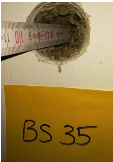
Wand unter Fenster Materialraum: Gipskarton [BS35] und Dämmmaterial hinter Gipskarton [BS36]
