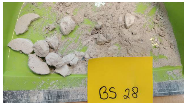
Wand hinter Heizung, Putz auf Leichtbeton [BS28]
