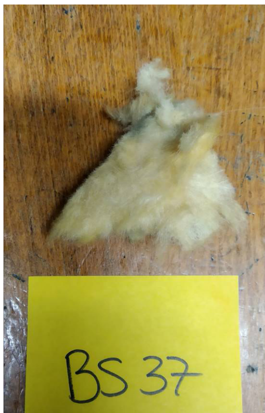
Dämmmaterial Rohrummantelung Leitung Decke [BS37]
