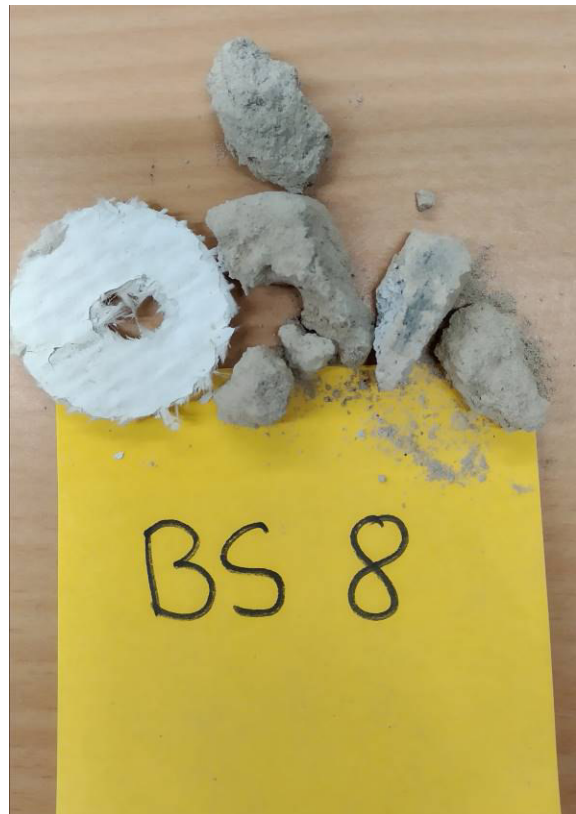
Strukturputz, Putz Wand hinter Heizung Klassenzimmer [BS8]
