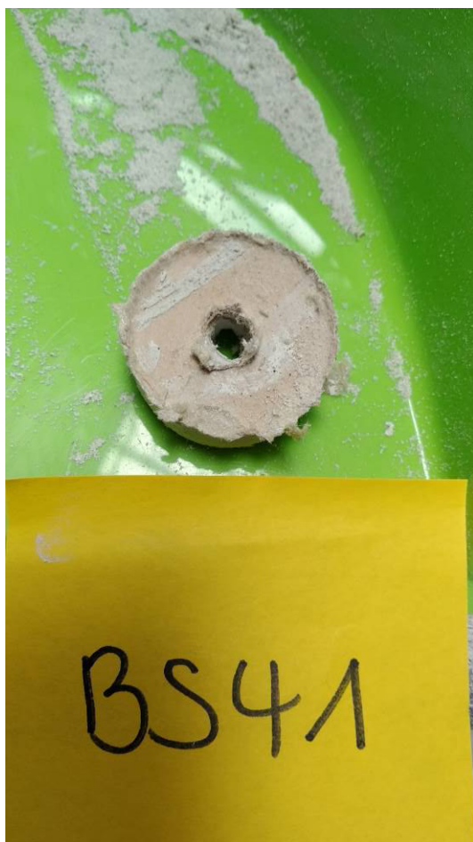
Außenwand Gipskarton auf Mineralwolle Archiv [BS41]
