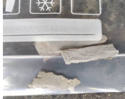
Fugenmaterial zwischen Träger und Fensterbrett [BS52]
