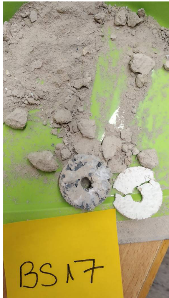
Außenwand hinter Heizung: Tapete, Putz, Heraklith, Styropor, Heraklith [BS17]
